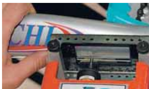
Il macchinario noleggiato dal Comune che imprime in modo indelebile sui telai delle bici il codice fiscale del padrone
