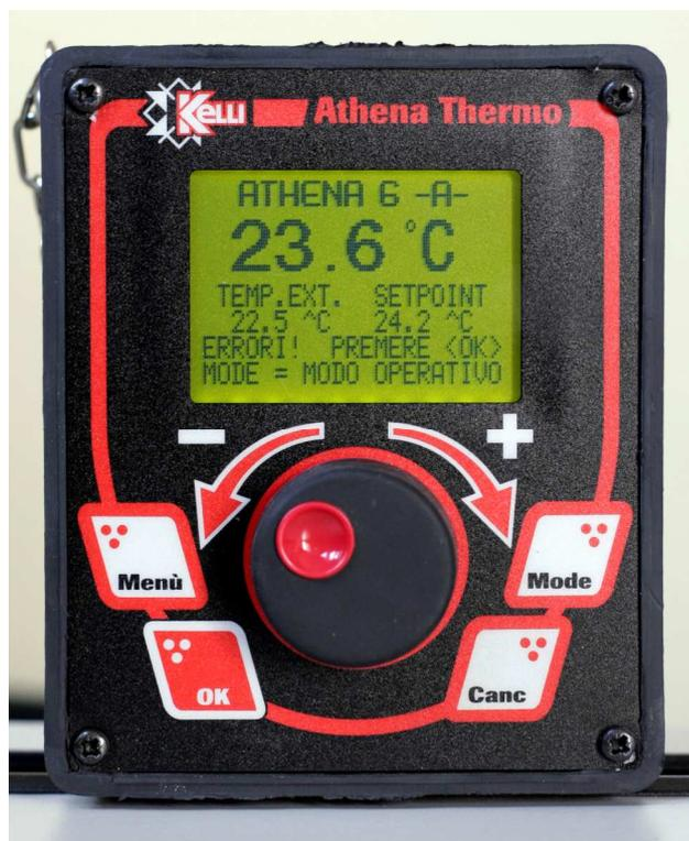
Premendo due volte in rapida successione il tasto OK si accede alla schermata di dettaglio relativa all'errore rilevato, Premendo due volte in rapida successione il tasto "CANC" si resetta il messaggio di errore:
